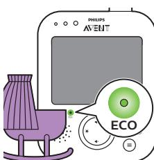
O visor e o som da unidade dos pais são desligados quando não é detetado qualquer som durante 20 segundos. A luz ECO acende-se a verde para indicar que o modo ECO está ativado. Durante o modo ECO, as transmissões do visor e do som são desligadas.
